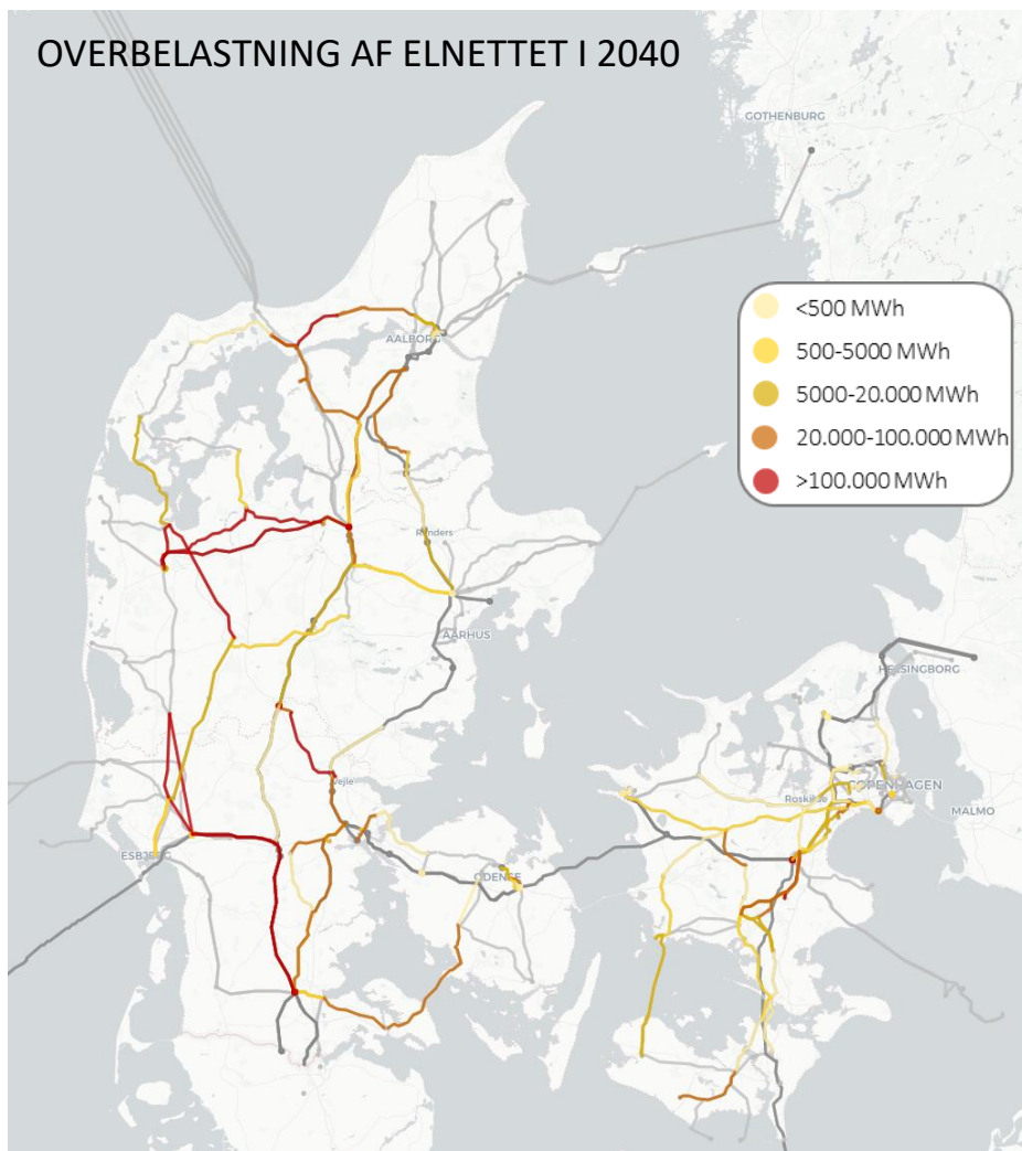
Figur 2 Kortet viser overbelastningsenergien på komponenterne i eltransmissionsnettet som følge af udviklingen i AF20. Opgørelsen er udarbejdet på baggrund af det eksisterende net og projekter, der er godkendt til etablering hos Energinet og myndigheder pr. juni 2021. Overbelastningsenergien angiver den energimængde, der skal aflastes på en forbindelse, hvis ikke der tages andre tiltag i brug. Kritikaliteten af et behov afhænger, ud over størrelsen, af hvad der udløser det (fx forbrug eller produktion) samt omkostningerne forbundet med at afhjælpe det. For mere information om overbelastninger og begreber – se Behovsanalyse for el.
