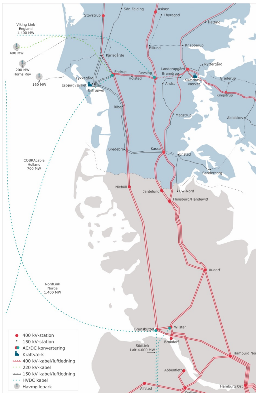
Figur 4: Vestkystforbindelsen fra Endrup via Niebüll til Brunsbüttel.
