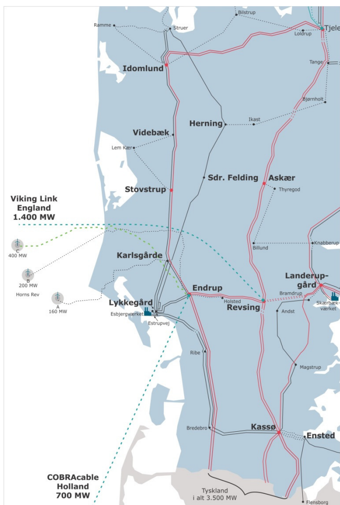
Figur 2 Indstillet løsning, 400/150 kV-kombiledning mellem Endrup og Idomlund studie 2035.
