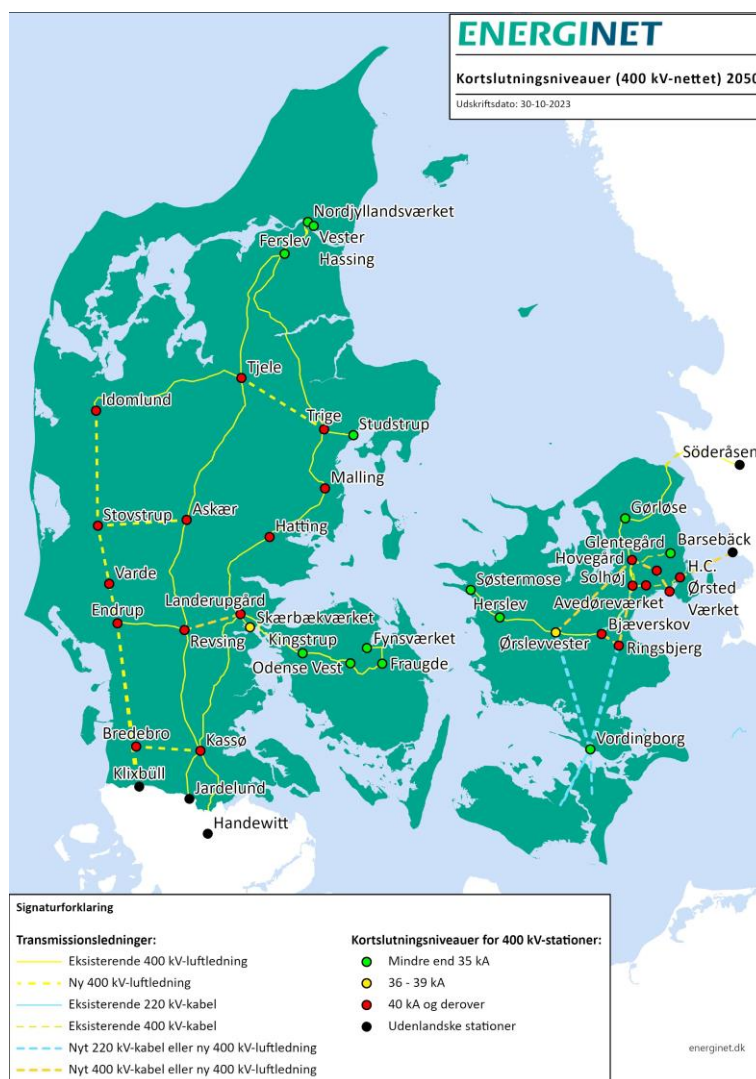
Figur 11 Visualisering af det forventede kortslutningsniveau i 400 kV-stationerne i Danmark i 2050.
