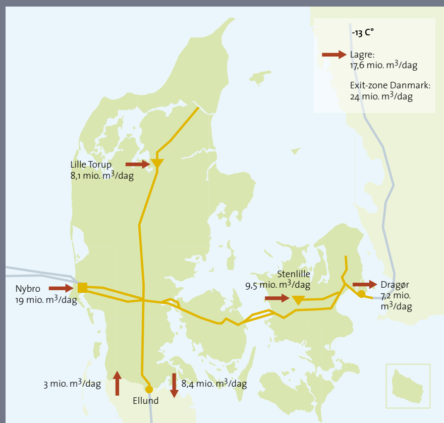
Figur 4-1: Prognose for en vintersituation med døgnmiddeltemperatur på -13^{\circ}\text{C} i 2010/2011 (normalsituation).
