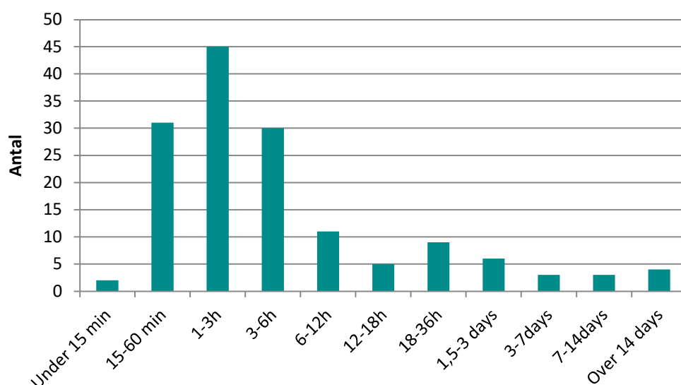
Figur 11 Antal havarier på HVDC-forbindelser i perioden 2012-2017 fordelt i forhold til havariets længde. Kilde: DISTAC.
