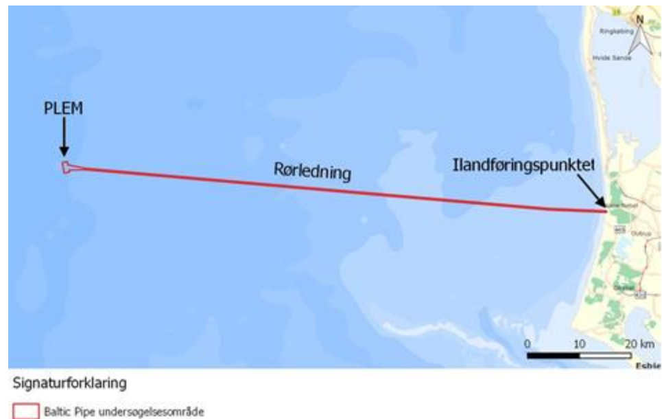
Figur 1. Kort over den endelige realiserede linjeføring af Baltic Pipe i Nordsøen fra den såkaldt PLEM (Pipeline End Manifold) forbindelse med tilkoblingspunktet til Europipe II til ilandføringspunktet ved Blåbjerg på den jyske vestkyst.
