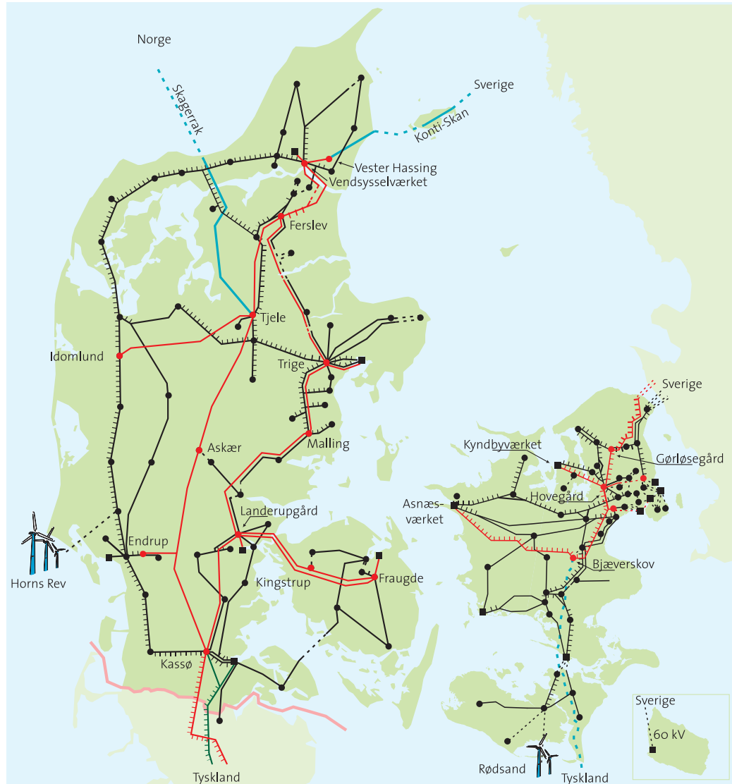
Figur 7.1 Eksisterende transmissionsnet primo 2006
