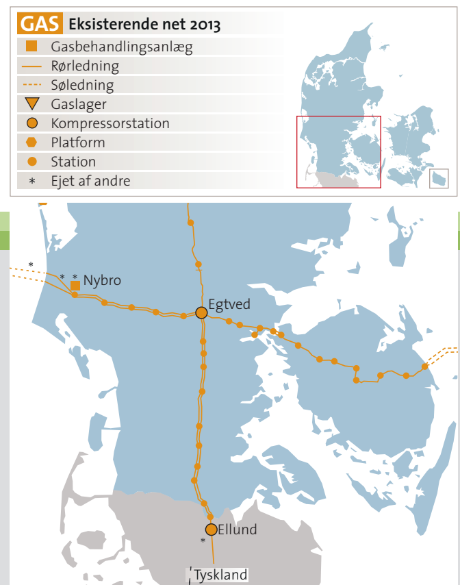
Figur 39: Gaskompressorstation i Egtved og ledningsdublering fra Egtved til Ellund.
