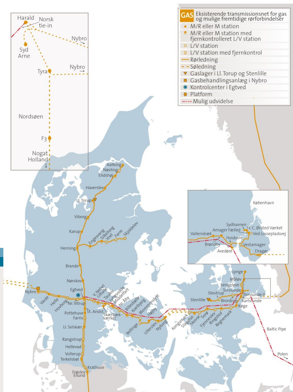
Figur 13: Eksisterende gastransmissionsnet og mulige fremtidige rørforbindelser
