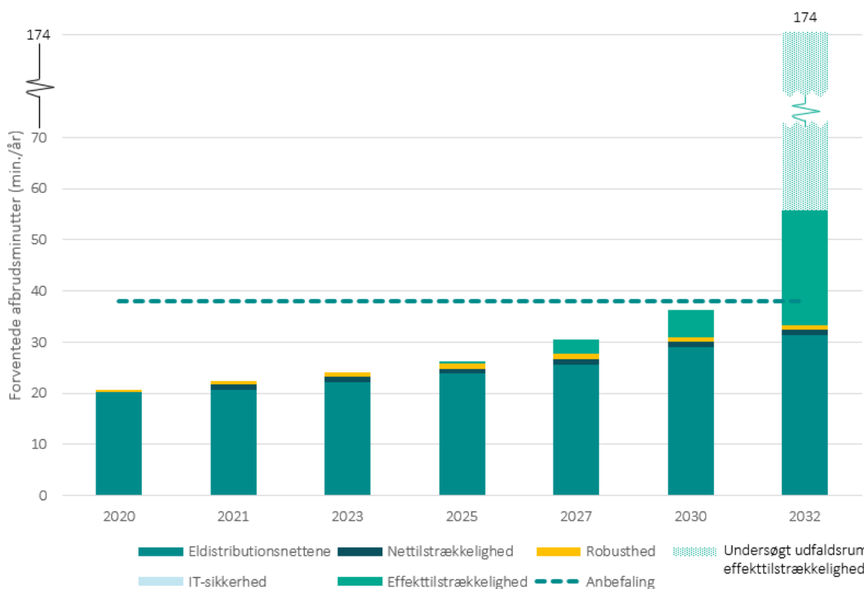
Figur 2 Forventet antal afbrudsminutter i det danske elsystem fra 2023 og frem til 2032, jævnfør redegørelsens prognose (basis-scenarie). Sammen med fremskrivningen er det anbefalede planlægningsmål markeret. Bemærk, at det anbefalede planlægningsmål er for et "normalt år", hvilket vil sige, at særlige hændelser ikke er dækket heraf. Dog er der i fremskrivningen af den forventede udvikling i effekttilstrækkeligheden inkluderet alle sandsynlige hændelser for udfald. Fremskrivning af effekttilstrækkelighed og følsomhedsanalyser er nærmere beskrevet i afsnit 4.1.
