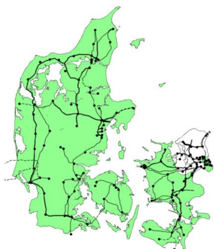
Figur 4 Det regionale eltransmissionsnet i Danmark (132-150 kV).
