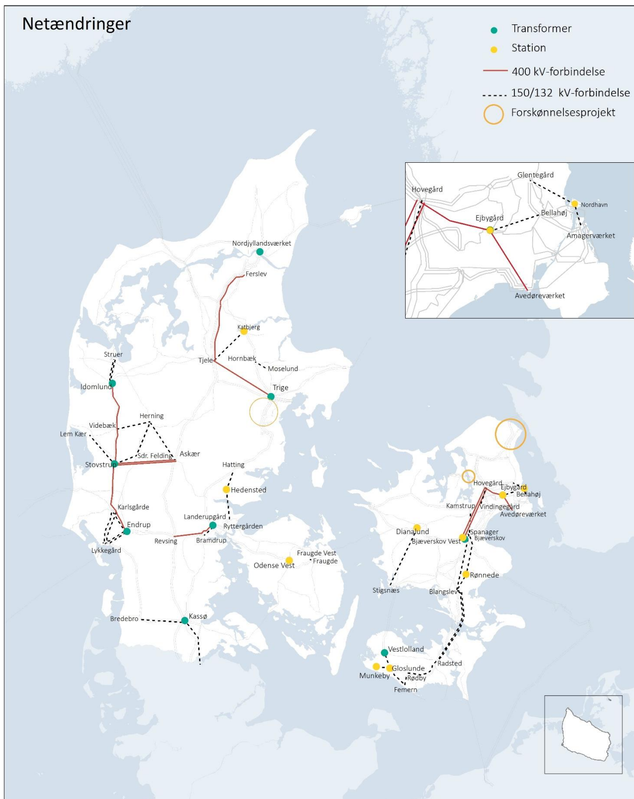
Figur 1 Mulige netændringer i eltransmissionsnettet frem mod den langsigtede netstruktur.
