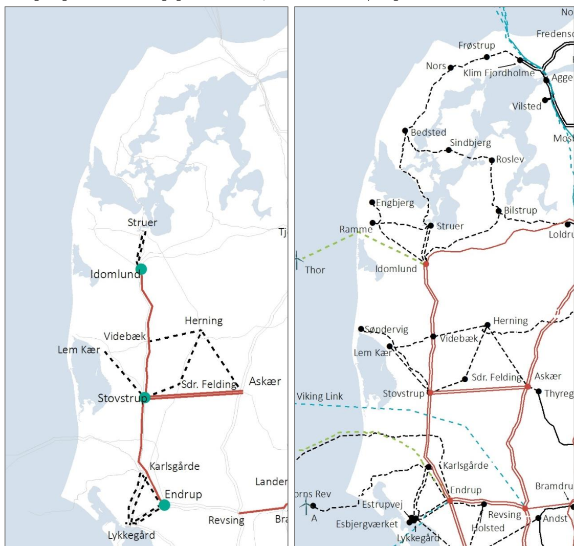
Figur 6 Netændringer i Vestjylland og den resulterende langsigtede netstruktur. Udklip fra Figur 1 og Figur 5.
