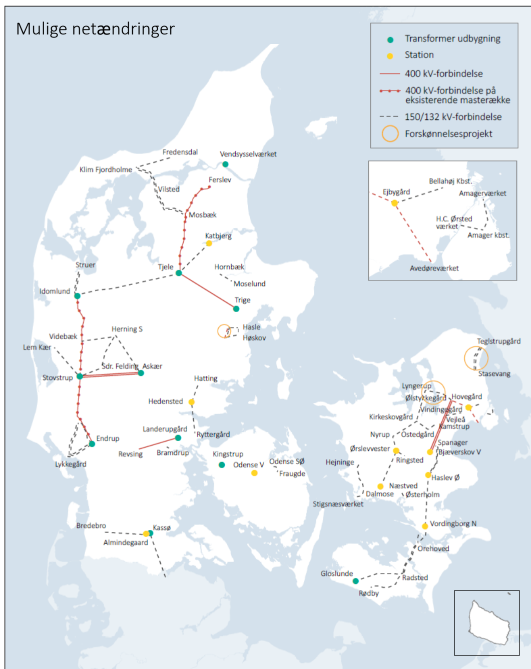
Figur 4 Mulige netændringer i eltransmissionsnettet som kan understøtte udviklingen i AF20. Kortet viser ændringer ud over de projekter, der havde opnået etableringsgodkendelse ved Energinet og myndighederne pr. juni 2021.
