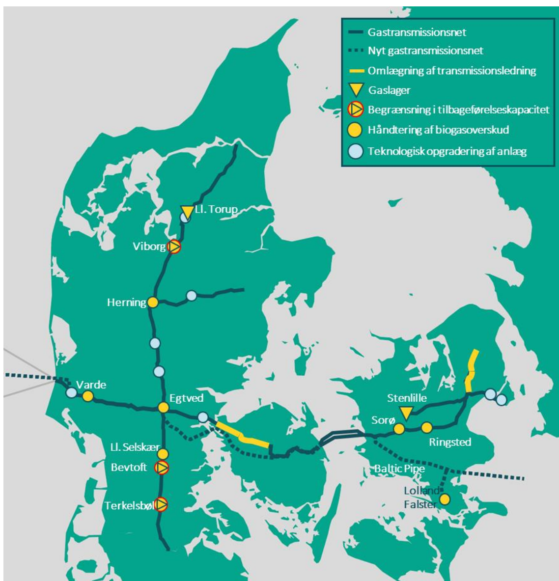
Figur 3 Kortet viser et udvalg af de centrale udviklingsbehov på kort og langt sigt i gastransmissionssystemet. For et samlet billede af udviklingsbehovene i gastransmissionssystemet henvises til Behovsanalyse for gas.
