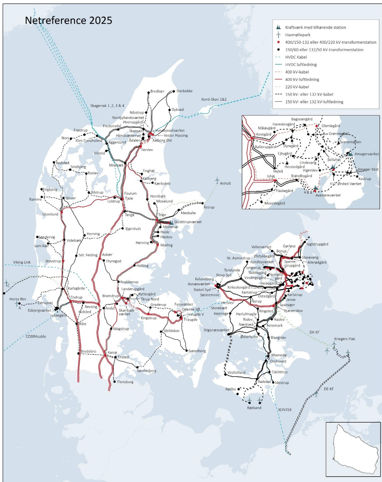
Figur 5 Netreferencen 2025 bestående af eksisterende eltransmissionsnet og godkendte anlæg.
