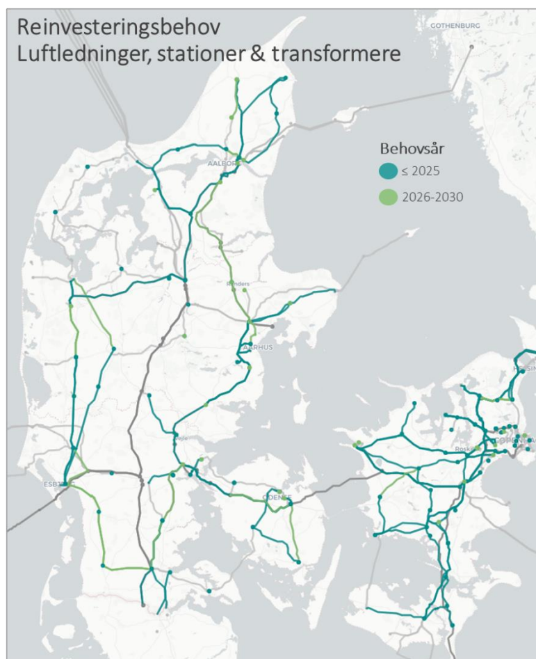
Figur 16 Reinvesteringsbehov for de kommende 10 år for luftledninger, stationer og transformere. Blå linjer/stationer står til re-investering før 2025, og grønne i årene efter og frem mod 2030.
