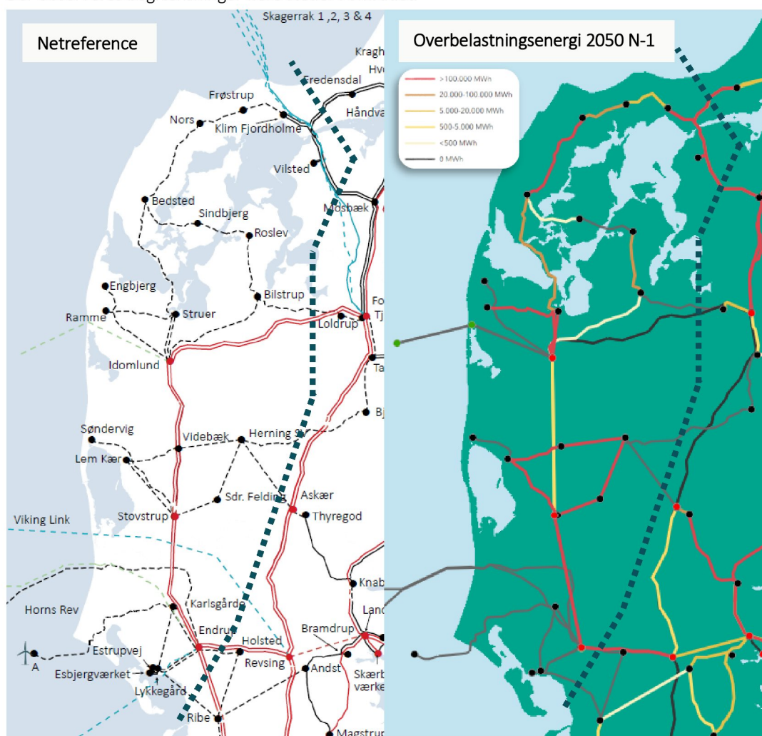
Figur 16 Netreferencen i Vest- og Nordvestjylland sammenstillet med overbelastningsenergien under hensyntagen til N-1 i AF22 2050 – udklip fra Figur 15. Den nye, men godkendte 400 kV-forbindelse mellem Endrup og Idomlund er tegnet ind som lige streger mellem stationerne og repræsenterer ikke det forventede tracé.
