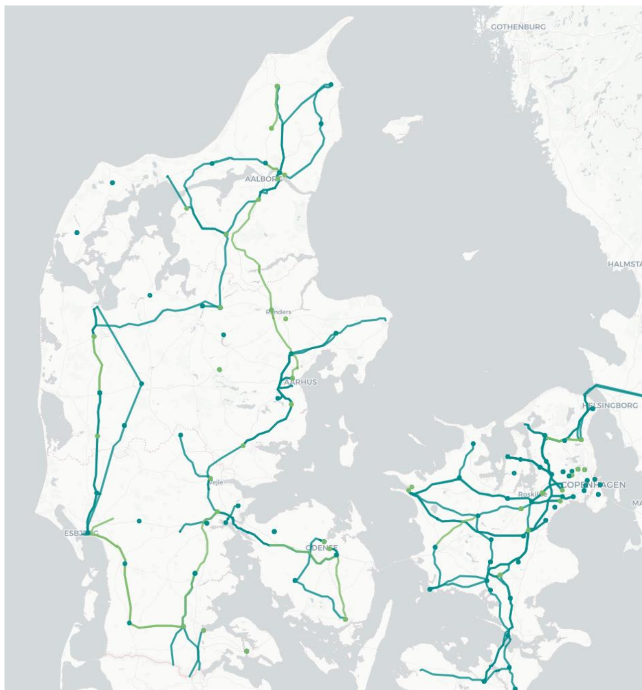
Figur 10 Nødvendige reinvesteringer i det danske eltransmissionsnet på grund af opbrugt levetid. Linjer og komponenter markeret med blå skal reinvesteres inden 2025. Linjer og komponenter markeret med grønt skal reinvesteres inden 2030.
