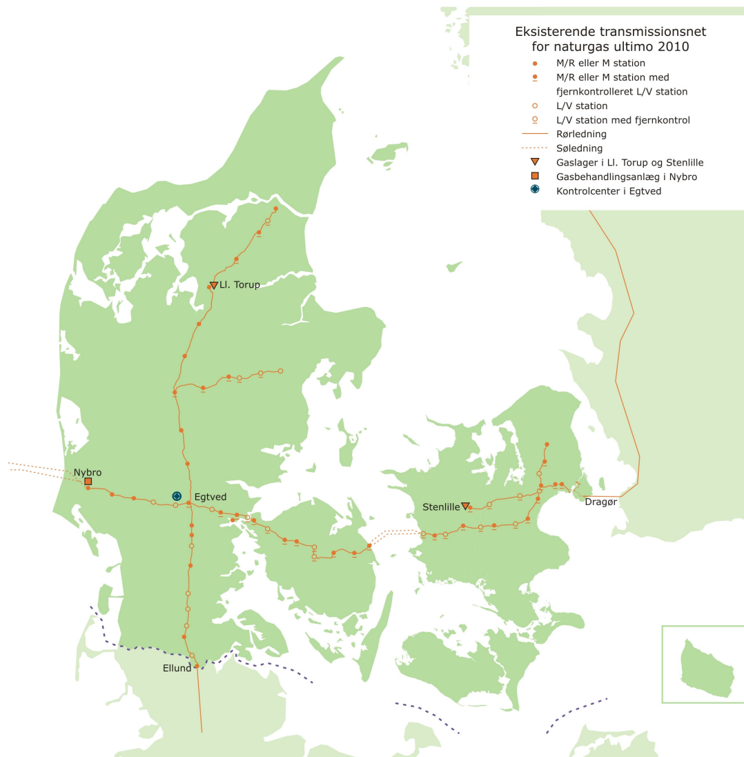
Figur 10 Gassystemet i Danmark ultimo 2010.
