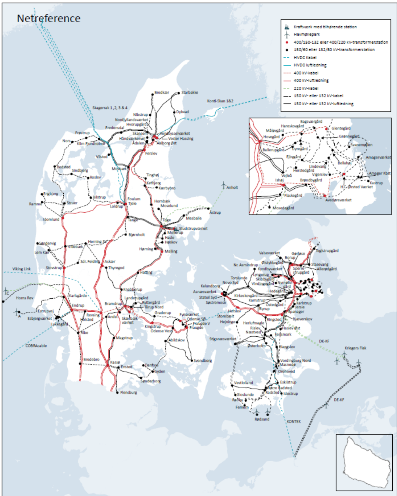
Figur 2 - Netreferencen - Eltransmissionsnettet når alle godkendte projekter er gennemført.
