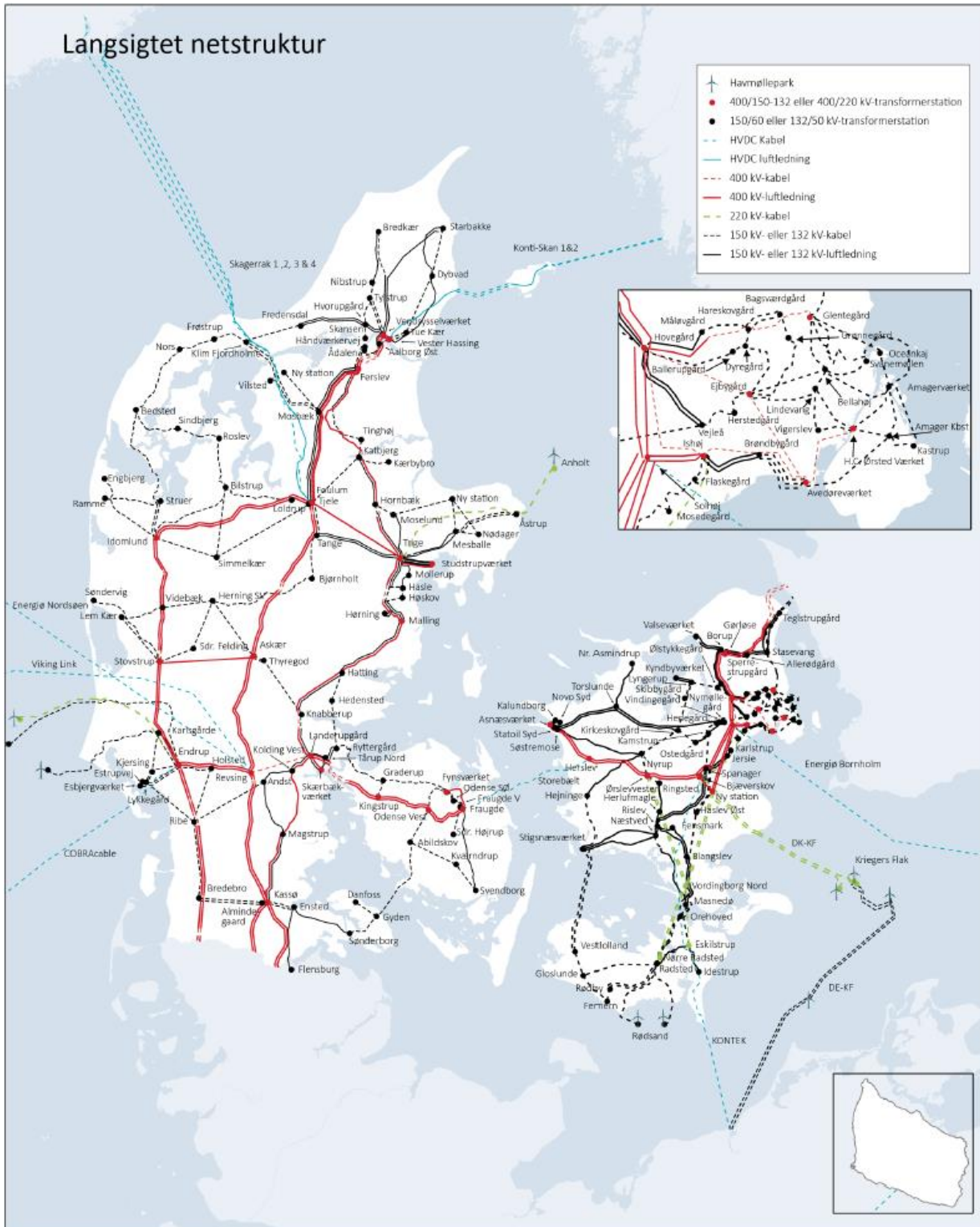
Figur 3 - Langsigtet Netstruktur for eltransmissionsnettet 2022.
