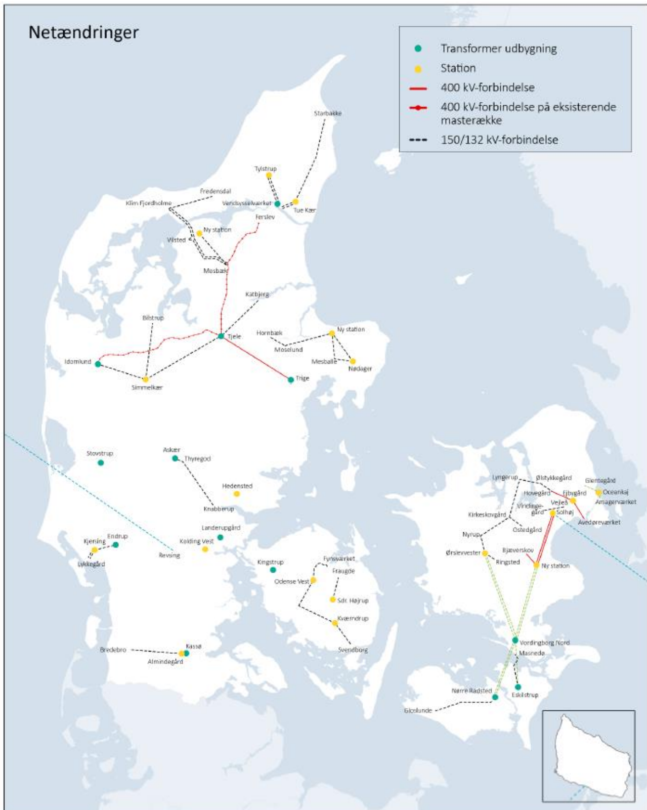
Figur 4 - Ændringer i den langsigtede netstruktur ift. netreferencen.
