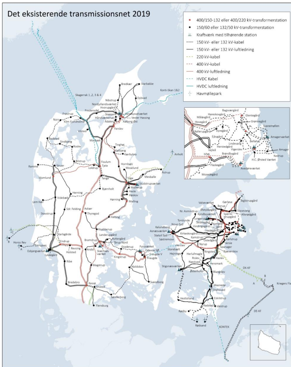
Figur 7 Det eksisterende transmissionsnet primo 2019.
