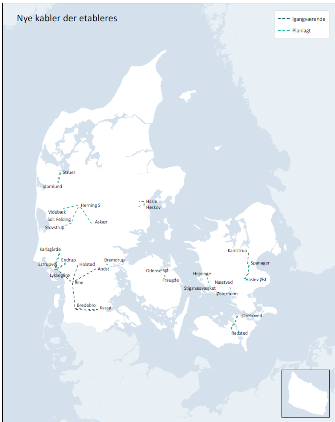
Figur 16 Markering af nye kabler der etableres som erstatning for de luftledninger der demonteres ved brug af midler fra PSO-puljen. Planlagte projekter repræsenteres projekter der er påbegyndt modning i Energinet. Planlagte projekter er projekter med en godkendt business case. Kortet repræsenterer ikke den fulde udmøntning af PSO-puljen.
