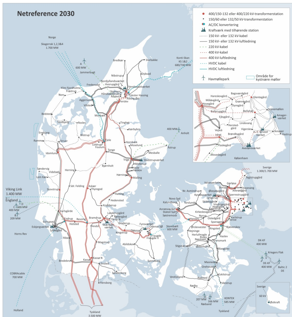
Figur 23 Forudsat netreference for 2030, hvor alle planlagte og igangværende projekter fra afsnit 4 forudsættes gennemført – men uden mulige projekter.
