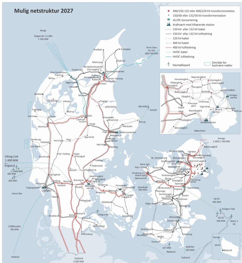
Figur 47 Netstrukturen for transmissionsnettet i Danmark på mellemlagt sigt.
