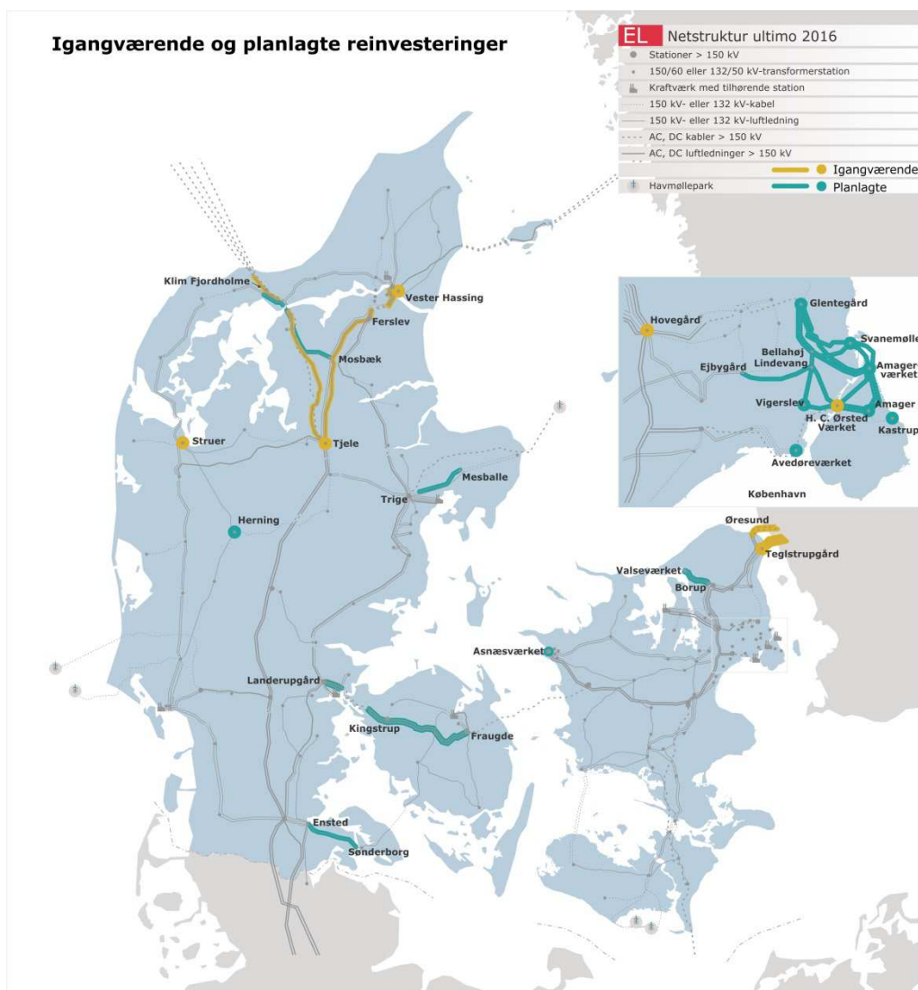
Figur 14 Den geografiske placering af de igangværende og planlagte reinvesteringsprojekter. Det samlede reinvesteringsprojekt, der omfatter flere 132/150 kV-transformerne i Danmark fremgår ikke af figuren.
