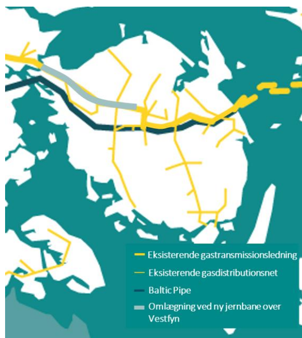
Figur 8 Kort, der viser hvor transmissionsnettet bliver berørt af etablering af ny jernbane over Vestfyn.
