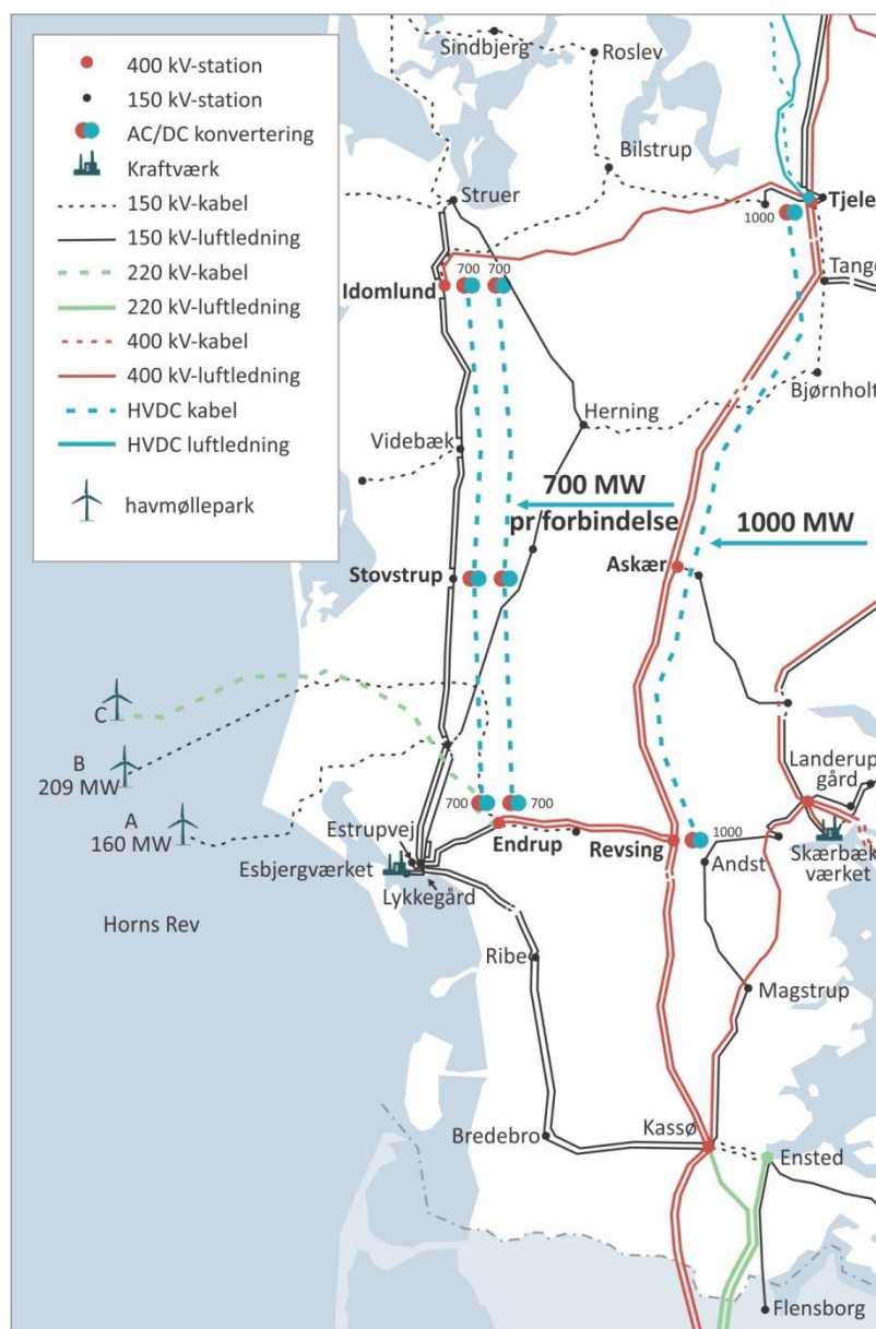
Figur 33 Opbygning af integreret multiterminal HVDC-koncept.
